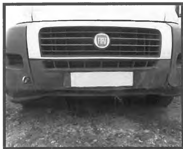
Poškodenie hnacieho ústrojenstva – únik prevádzkových kvapalín
