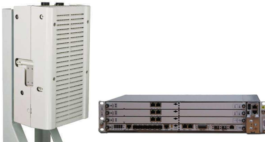
Obrázok 1, Rádiová prístupová časť - RRH a BBU jednotka
