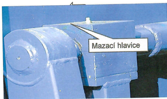
Pozícia 5 : Ložiskové domce vyklápacieho zariadenia.
