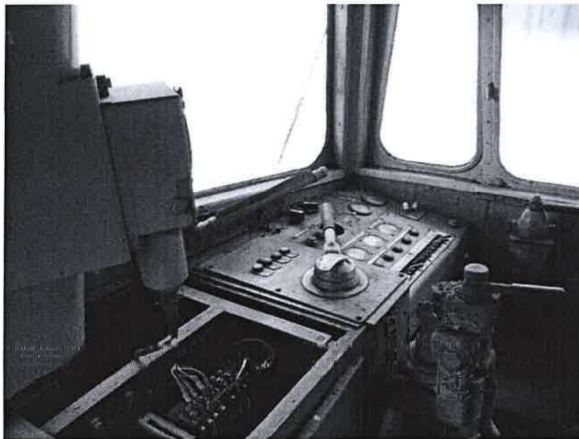
Meracie prístroje a ovládače na riadiacom pulte I. stanovišťa
