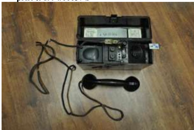
42. Telefón poľný nemecký 33 (Feldfernsprecher 33) prír. č. 1994/00037 S
