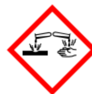
GHS05 - korozivní a žíravé látky
