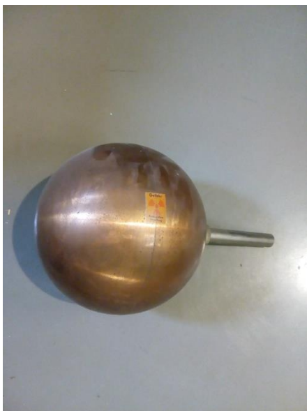
Obr. č. 2 Rádioaktívna guľa guľového iskrišťa – predmet likvidácie
