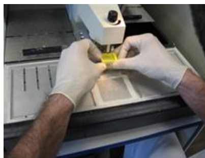
Obrázok 7 zalievanie vzorky parafínom do plna
