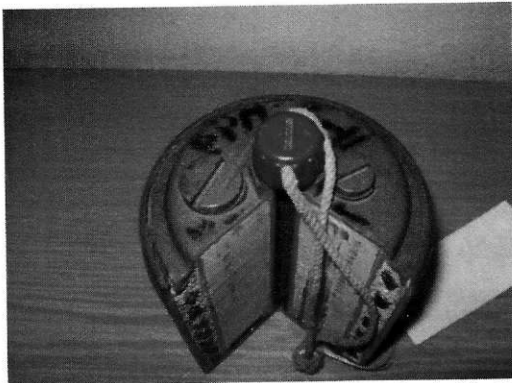
Mína cvičná, protipechotná, šrapnelová (Cv-PP-Mi-Šr)- rez
