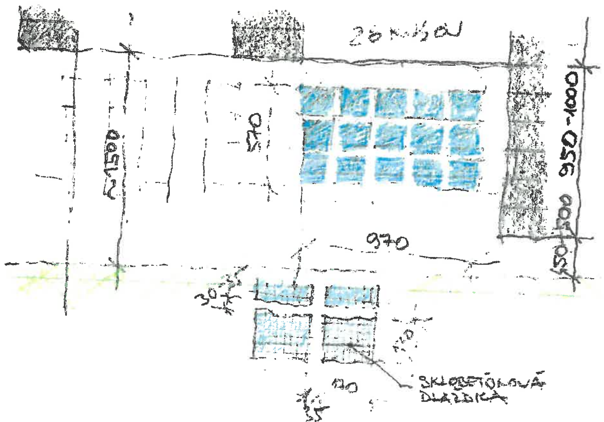
Základné rozmery sklobetónových tvárnic – anglické dvorce.
