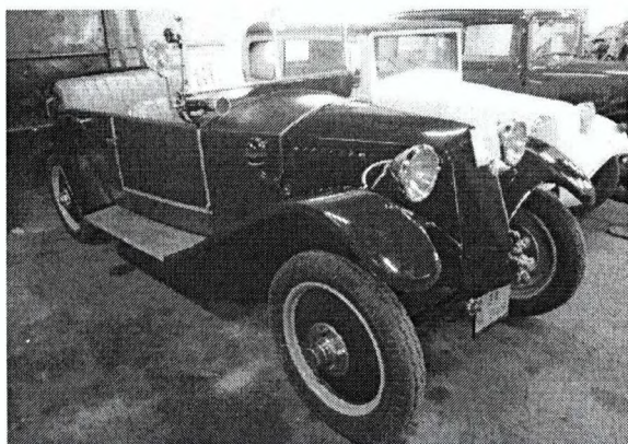
automobil TATRA T 12 , s plátenou sťahovacou strechou rok výroby 1929, farba modrá, objem 1056 cm 3 , výkon 15k
