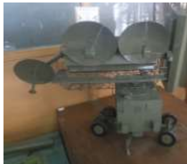
Maketa- anténová kabína (PV) navádzacieho rádiolokátora RSN-75V (PF 2019/11)
