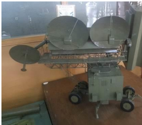
15. Maketa- anténová kabína (PV) navádzacieho rádiolokátora RSN-75V (PF 2019/11)
