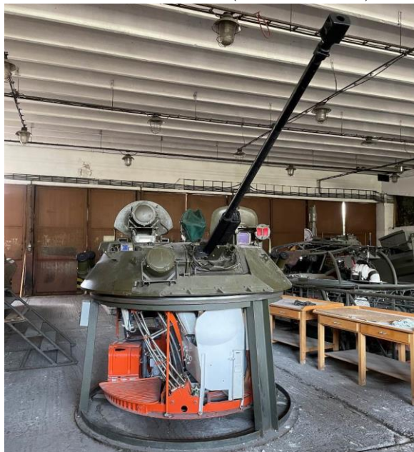
15. Maketa- anténová kabína (PV) navádzacieho rádiolokátora RSN-75V (PF 2019/11)
