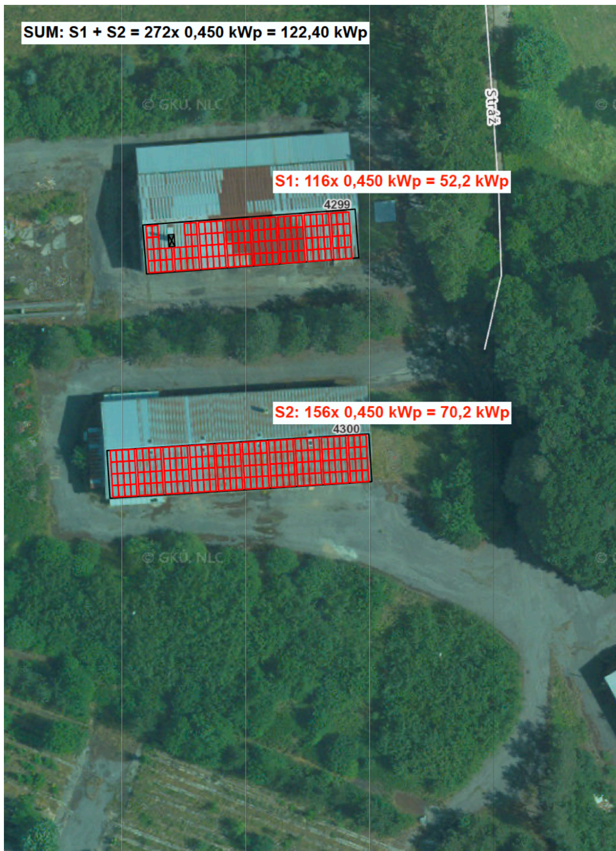
Obrázok 3: Uvažované umiestnenie fotovoltaických panelov vo Variante B
