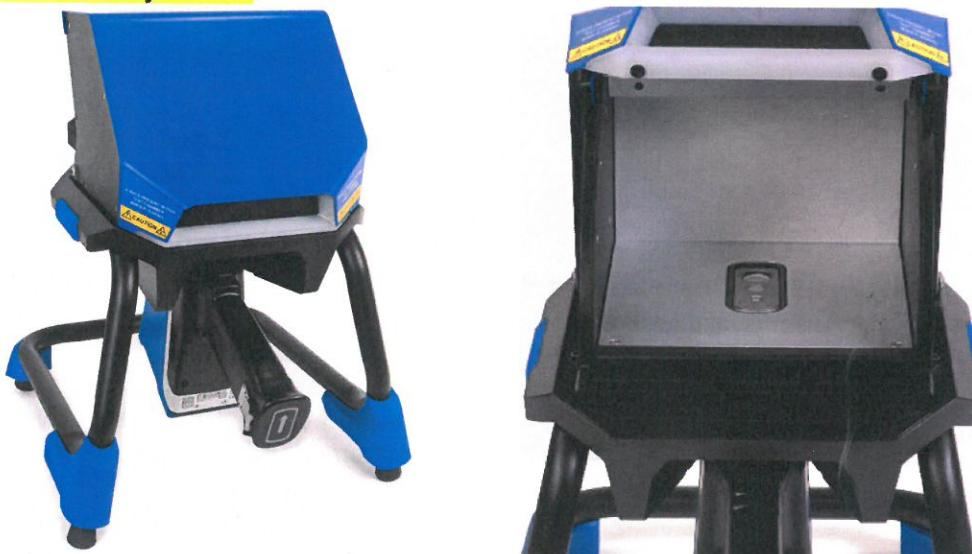
Umožňuje komfortní měření drobných vzorků a vzorků v kyvetách apod.
