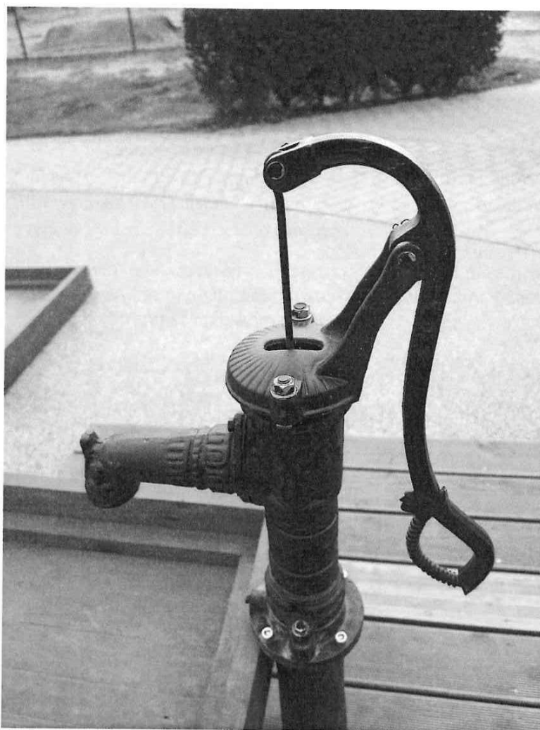
Obr. č. 7. Rukovať ručnej pumpy s dvoma kolíkmi pred zimnou demontážou.
