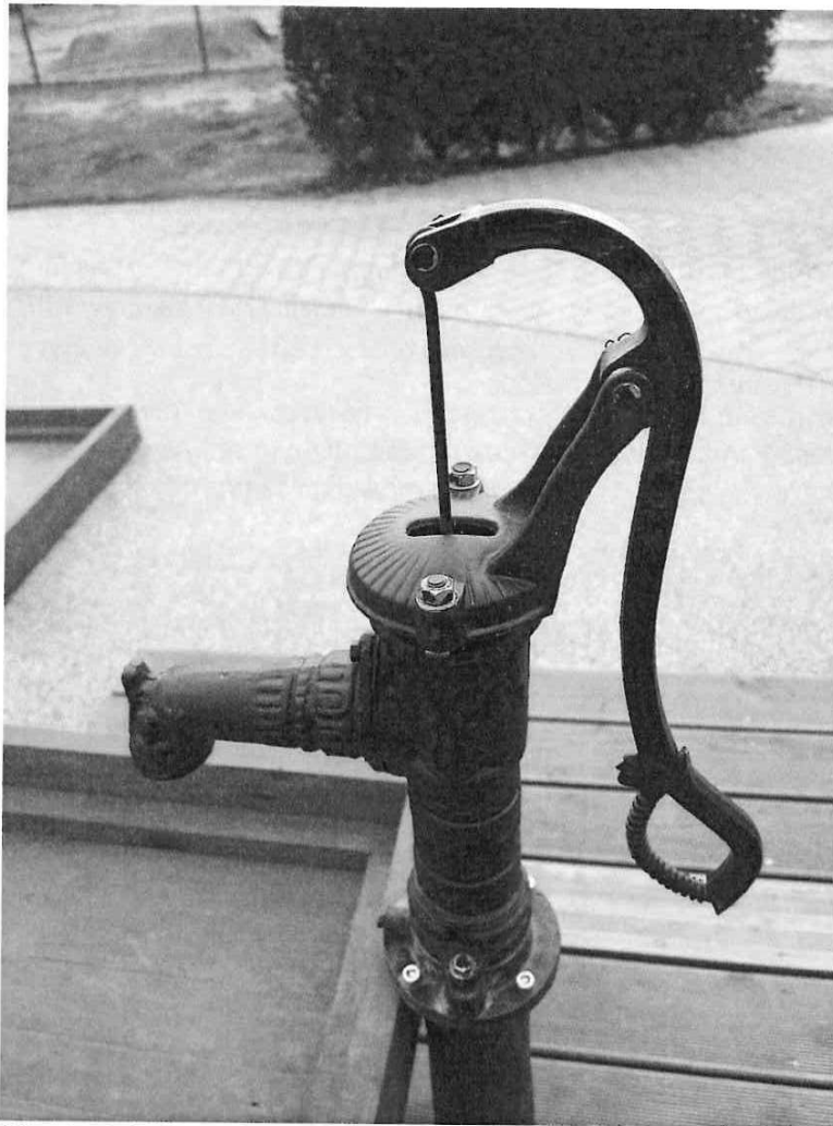
Obr. č. 7. Rukoväť ručnej pumpy s dvoma kolíkmi pred zimnou demontážou.
