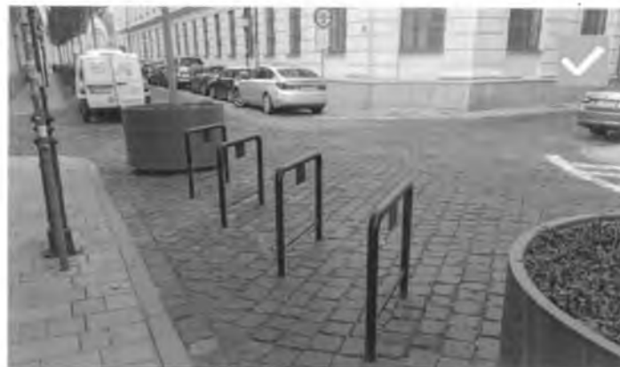
06 Vhodne osadené cyklostojany v sieti ostatných prvkov verejného priestoru rešpektujúce ich rytmus a zároveň nahrádzajúce zahradzovacie stĺpiky. Hranzšova, Kolárovo námestie
