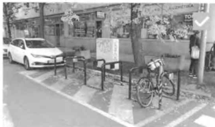
09 Vhodne osadené stojany v parkovacom pásu v blízkosti prechodu pre chodcov
