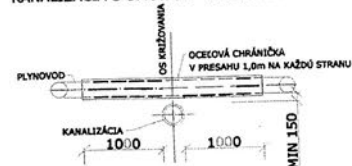
KANALIZÁCIA S ÚPRAVOU - MENEJ AKO 15CM
