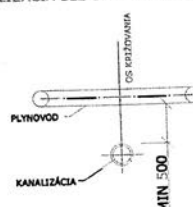
KANALIZÁCIA BEZ ÚPRAVY - NAD 50CM
